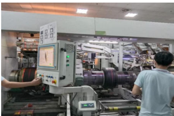
Công đoạn định hình lớp bằng máy tự động (lắp ráp các bộ phận)
